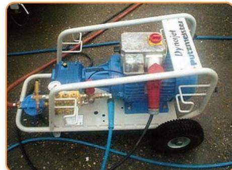
Die Hochdruck-Reinigungsgeräte arbeiten mit einem variabel einstellbarem Druck.
